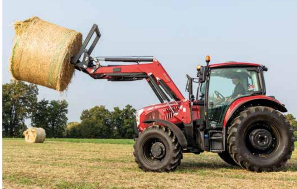
**Frontkraftheber.** Verwendung mit Frontlader.
